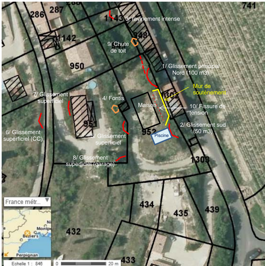
illustration 7 – Site 1, constat des désordres
