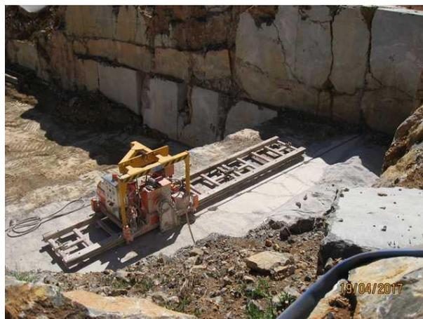
Fig 9 : Haveuse sciant verticalement le gradin
