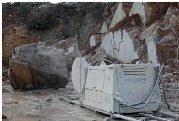
Fig 10 Scieuse à fil diamanté
