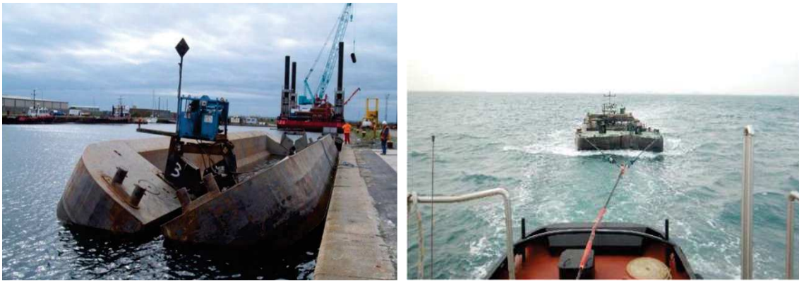
Figure 22 : Exemple de chaland fendable à quai et remorqué en mer
