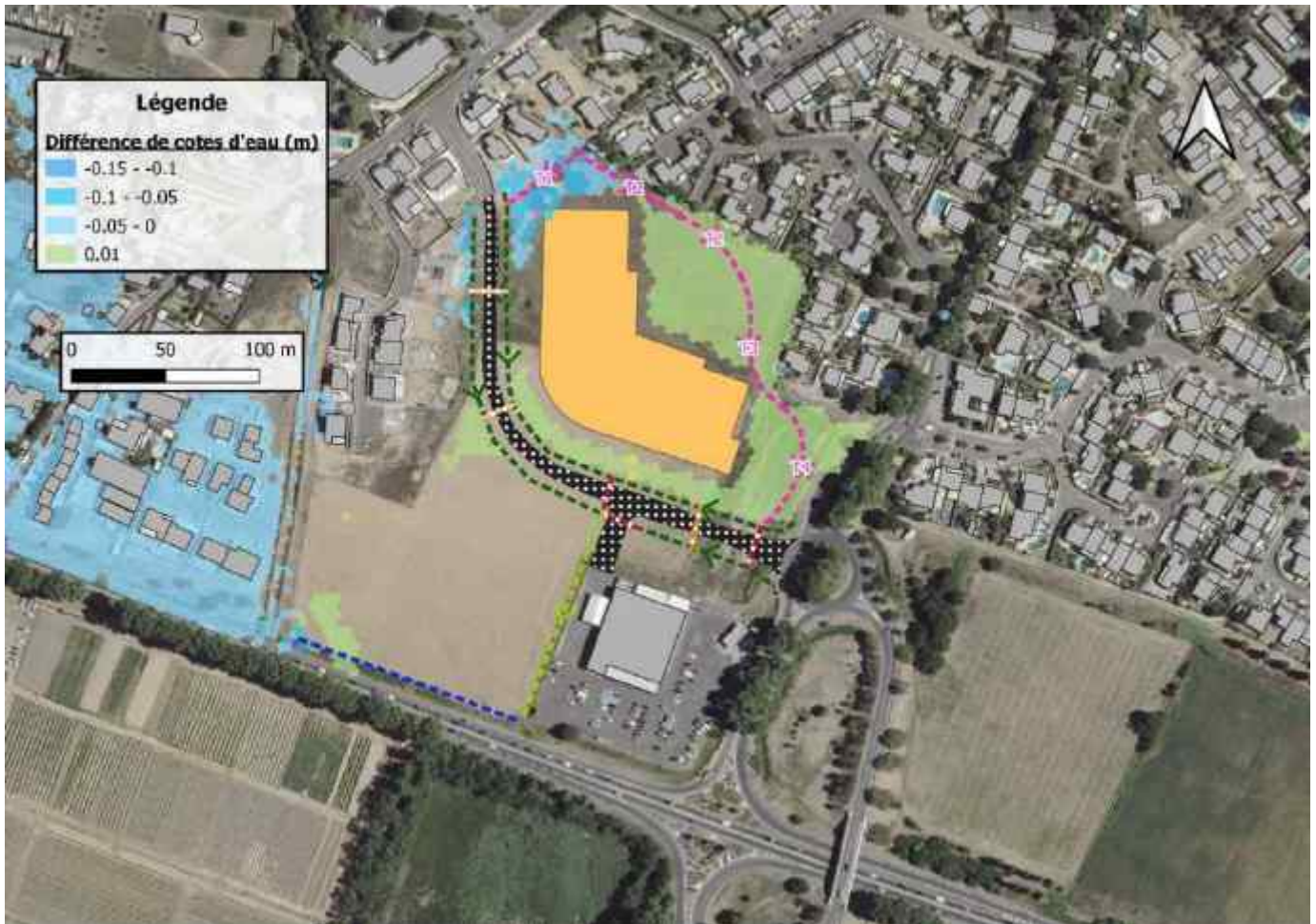
Figure 43 : Incidence des aménagement projetés, avec les mesures adoptées par le projet, sur les cotes d'eau avec une crue de l'Orb ;
