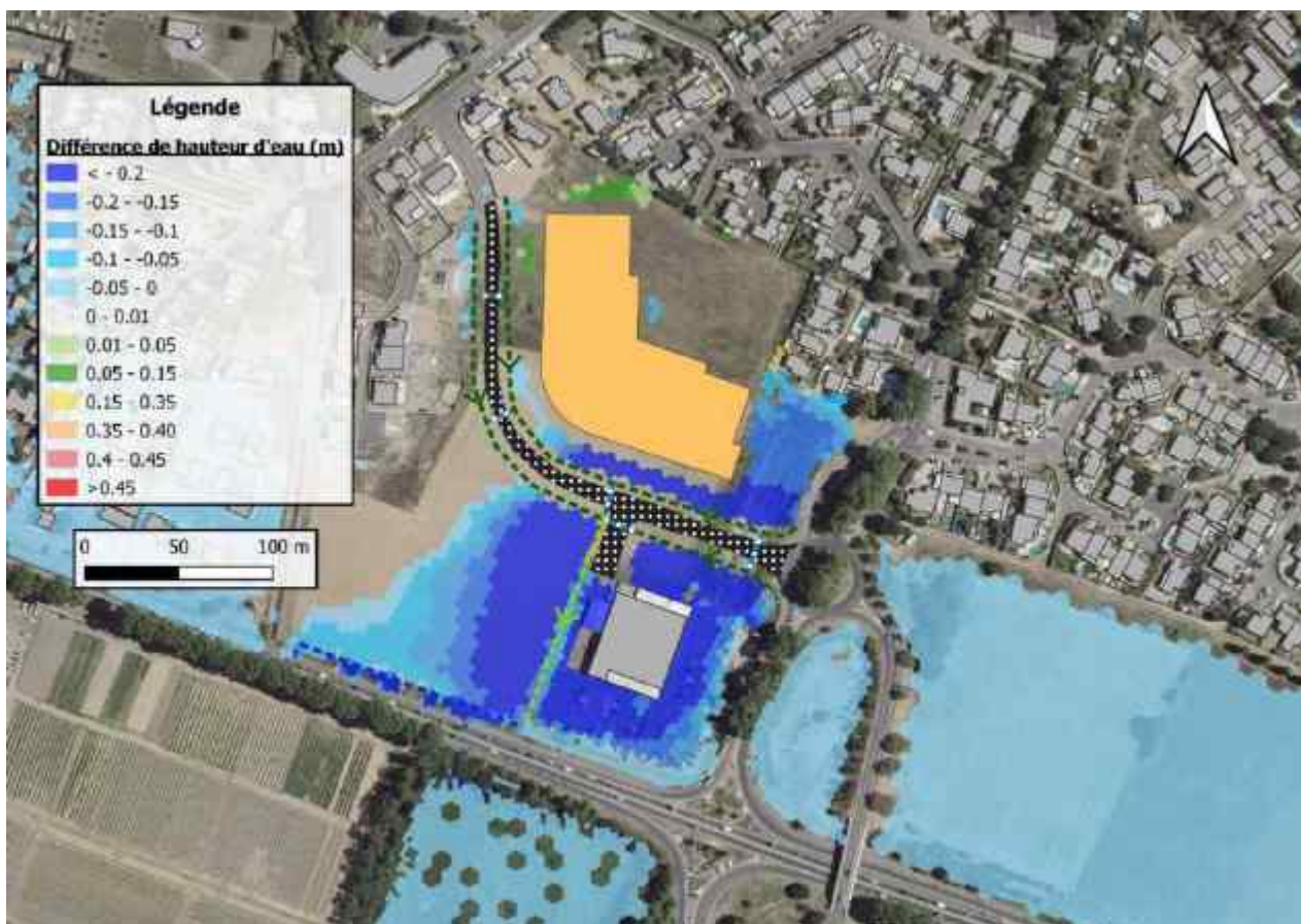
Figure 30 : Incidence de la déconnexion du déversoir du Malrec sur les hauteurs d'eau
