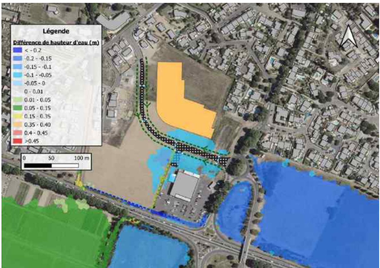
Figure 29 : Incidence de la déconnexion du déversoir du Malrec sur les hauteurs d'eau Hauteurs d'eau en situation projetée sans déversoir - Hauteurs d'eau en situation projetée avec déversoir
