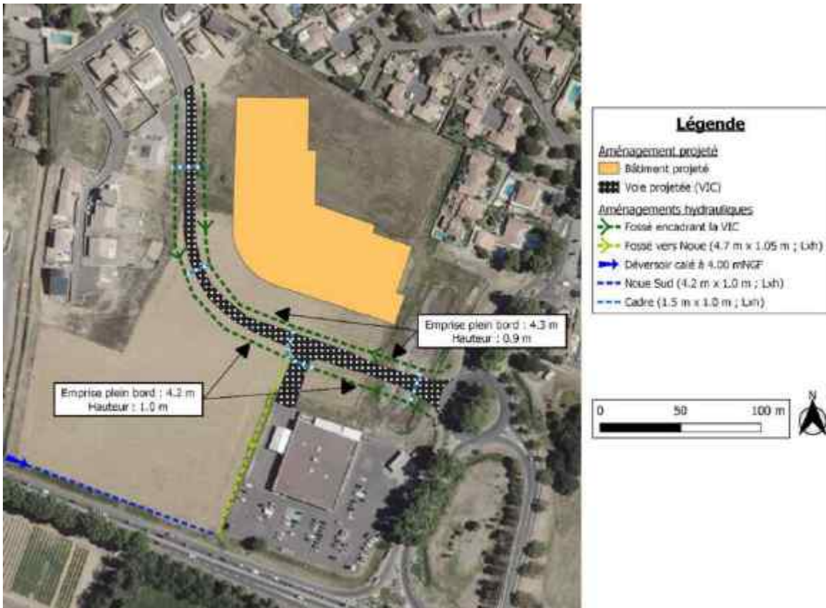
Figure 23 : Détail de la situation projetée
