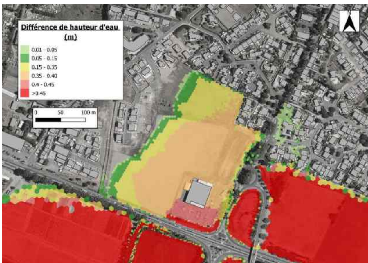
Figure 18 : Influence d'une crue de l'Orb sur les hauteurs d'eau Hauteurs d'eau avec crue de l'Orb - hauteurs d'eau sans crue de l'Orb
