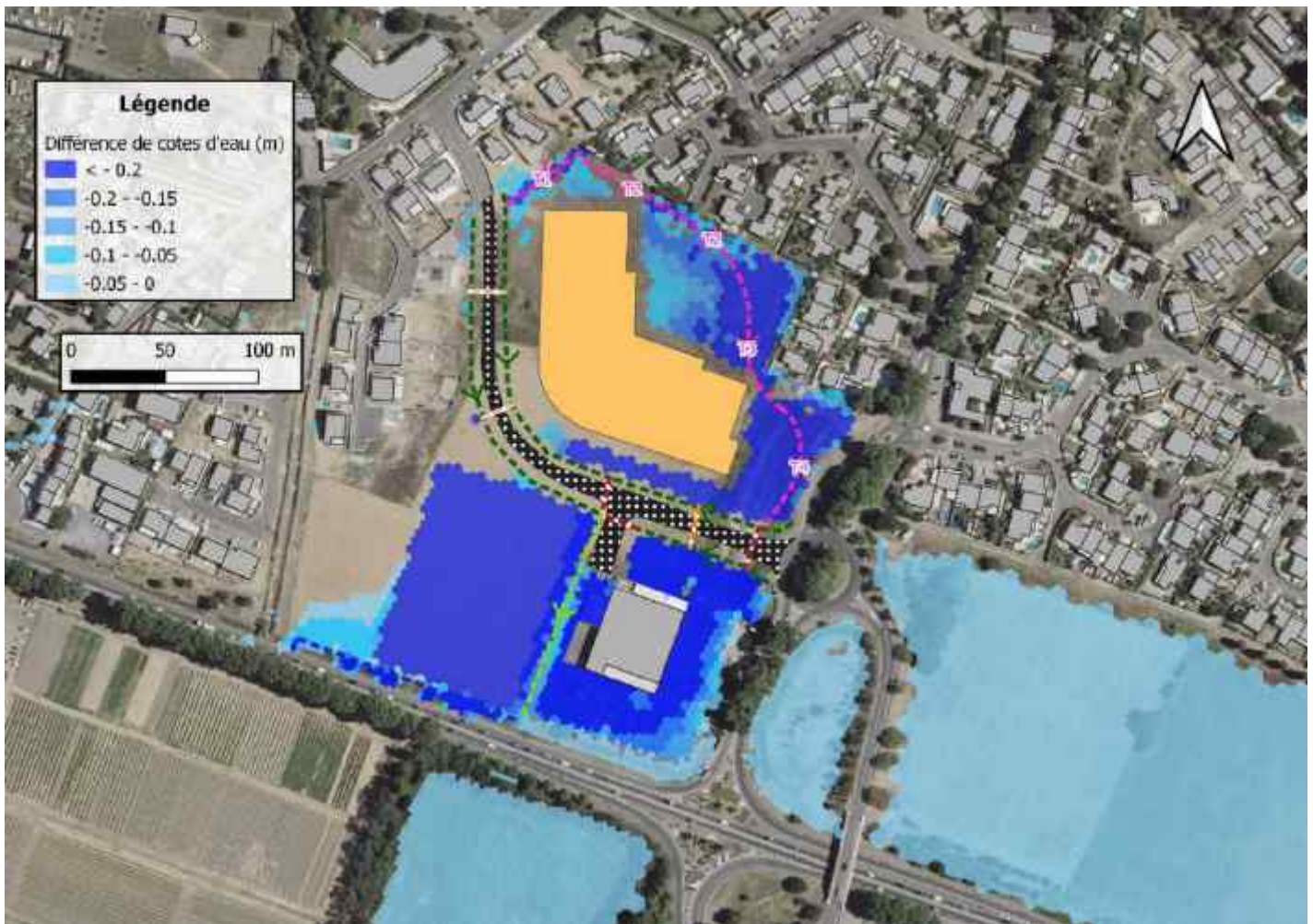
Figure 38 : Incidence des aménagement projetés, avec les mesures adoptées par le projet, sur les cotes d'eau ;
