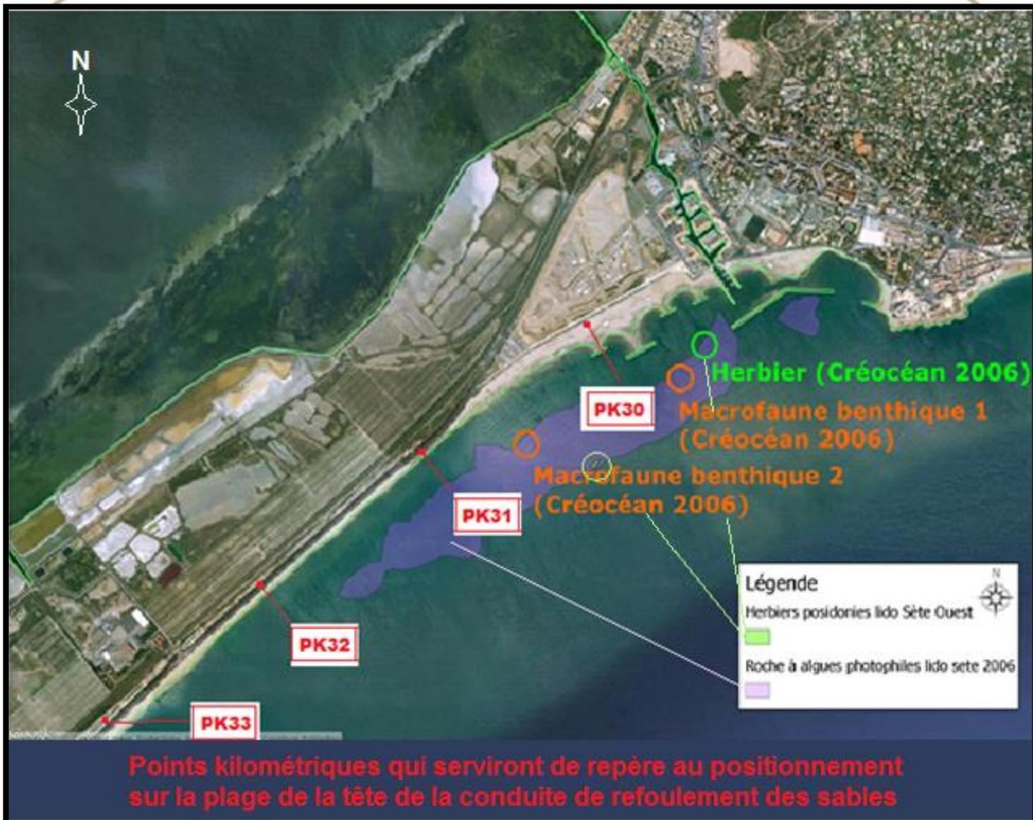
Les appareils de mesures seront placés aux mêmes endroits que pour les mesures réalisées lors de l'état initial afin de pouvoir faire un comparatif au fil de l'eau avec les données à  $t_0$ . Ce suivi, couplé à la surveillance du panache en ULM, permettra d'identifier les éventuels risques de sédimentation des herbiers de posidonie et de pouvoir agir rapidement en réalisant un nettoyage localisé par plongée des herbiers. Ce nettoyage est largement réalisable étant donné leur faible étendue.
