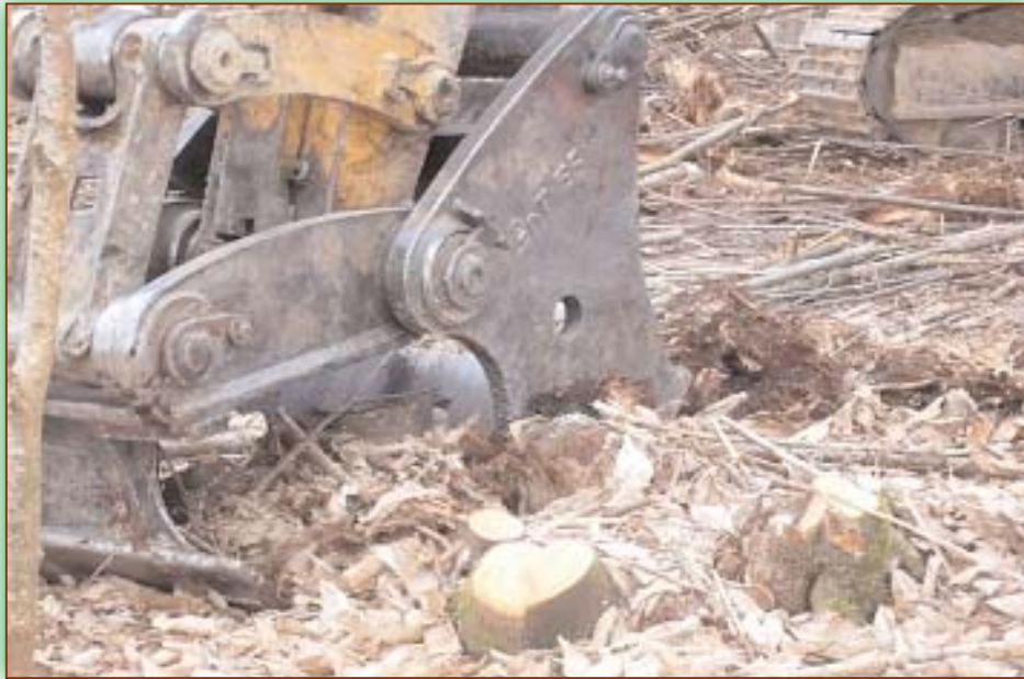
Extirpation au croque souches - CRPF Limousin
