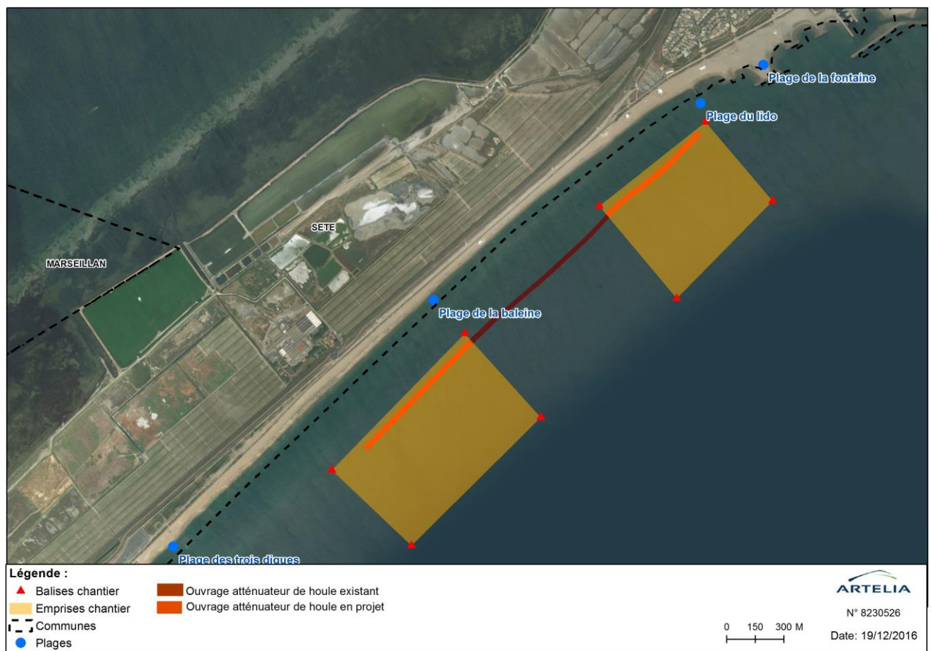
Fig. 80. Schéma de principe de positionnement des bouées de chantier
