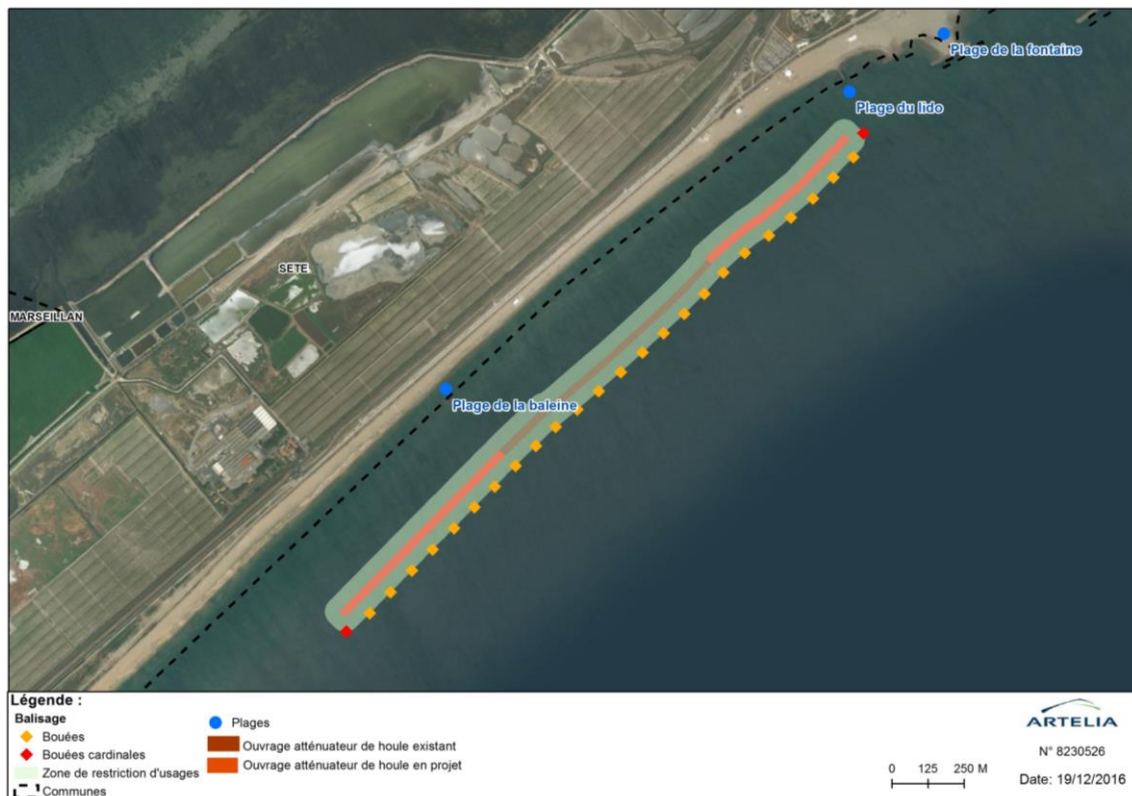
Fig. 76. Signalisation de l'ouvrage atténuateur de houle
