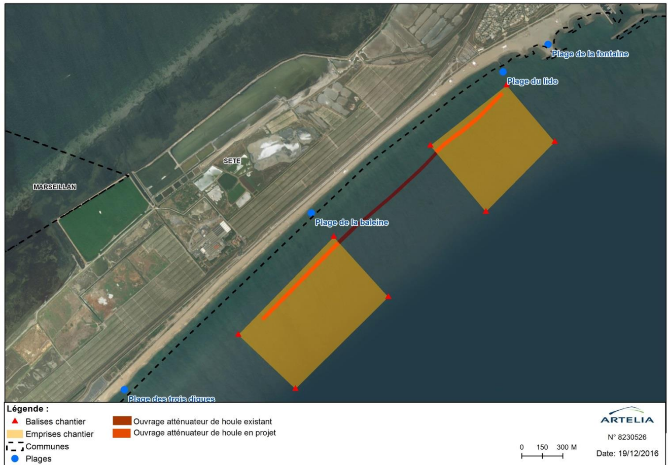
Fig. 9. Schéma de principe de positionnement des bouées de chantier
