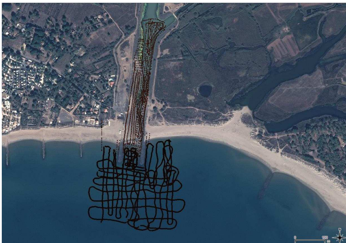
Fig. 5. Tracés des profils réalisés lors du levé topo-bathymétrique (Source : EID Méditerranée)
