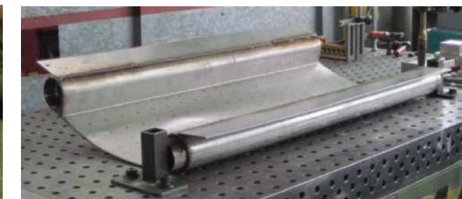
Figure 19 : Échangeur installé dans un ovoïde existant (Rabtherm), échangeur pour collecteur existant (Uhrig) (Source : Lyonnaise des Eaux)
