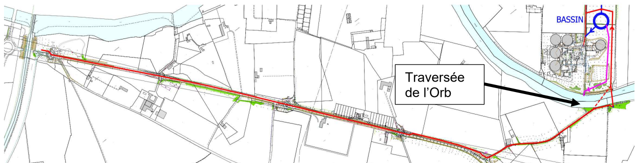
Figure 4 : Vue du projet de pose du réseau de transfert de la rive droite vers le bassin et la STEP
