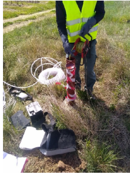
Piézomètre SC5 (position aval)
