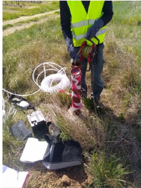
Piézomètre SC5 (position aval)
