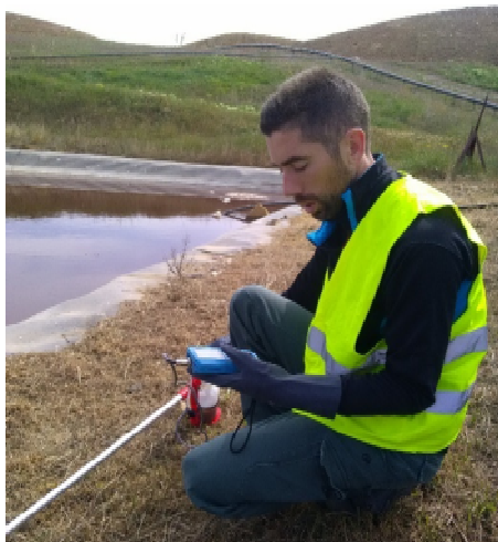
Figure 4 : Prise de mesures physico-chimiques sur l'échantillon du bassin lixiviats.
