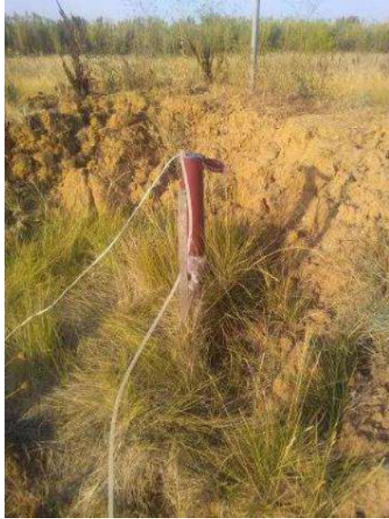
Piézomètre SC3 (position aval)
