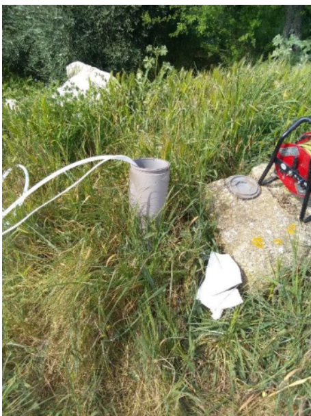
Piézomètre PZ1 (position amont)
