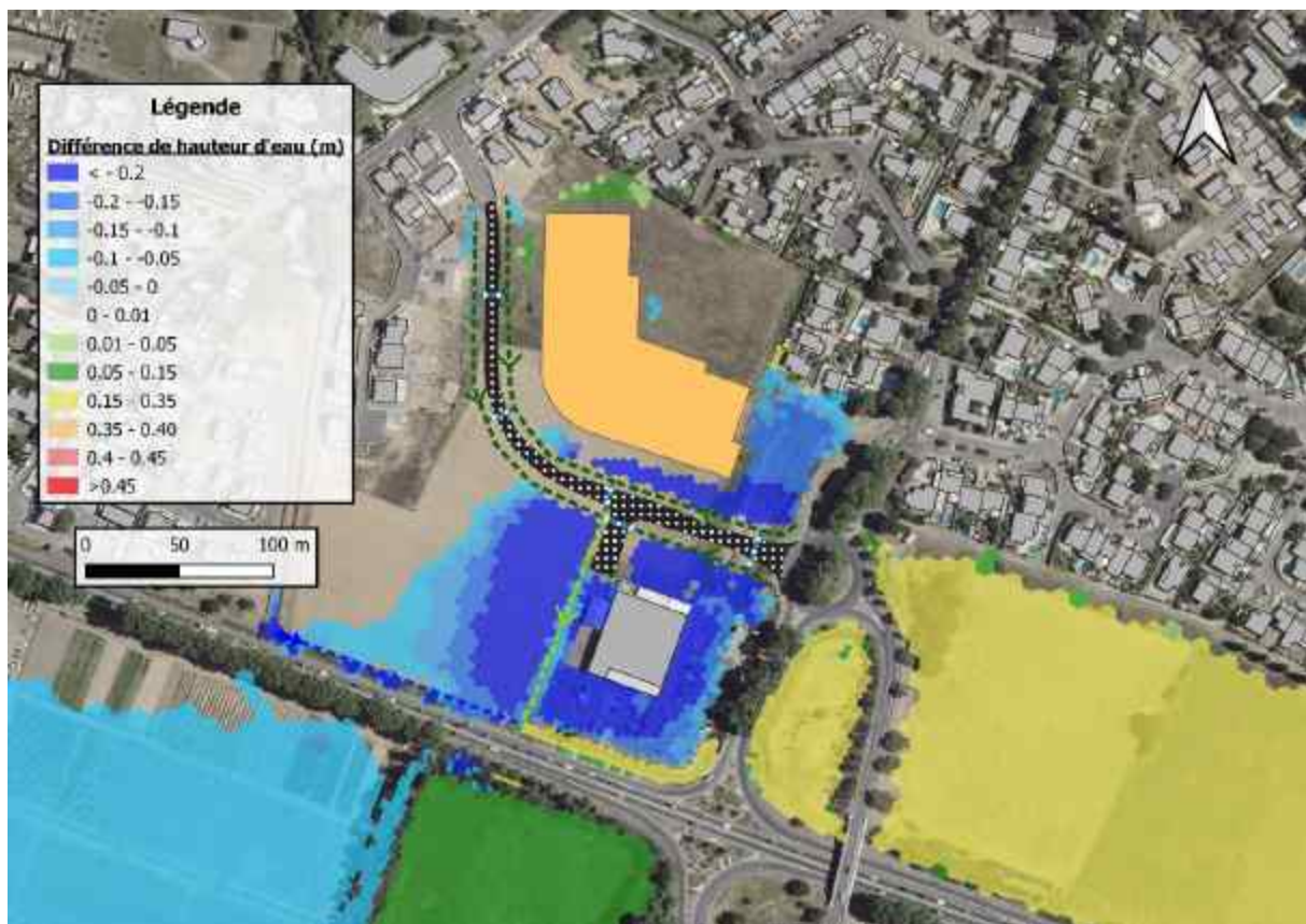
Figure 25 : Incidence des aménagements projetés sur les hauteurs d'eau Hauteurs d'eau en situation projetée – Hauteurs d'eau en situation actuelle
