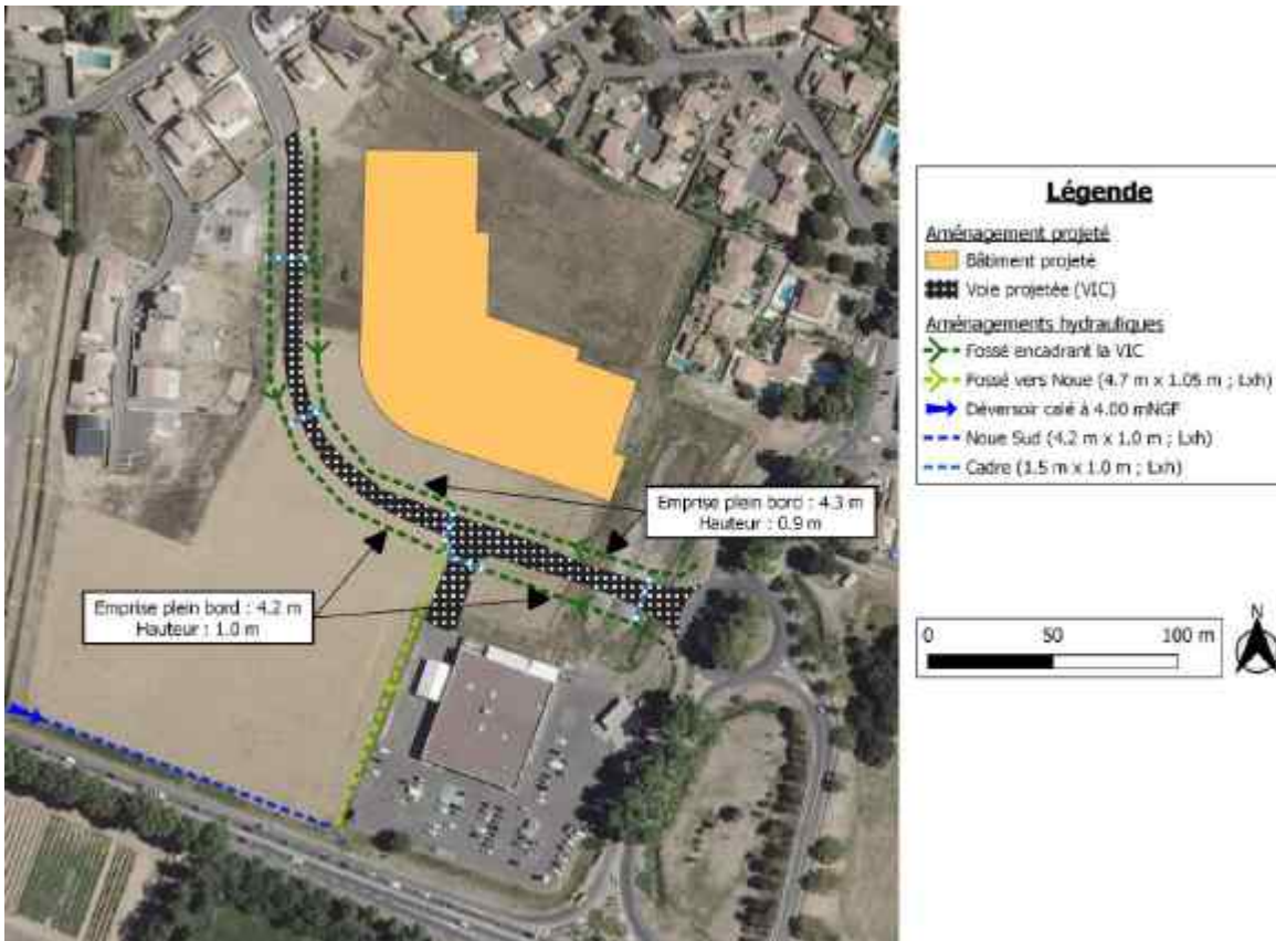
Figure 23 : Détail de la situation projetée
